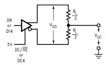
Figure 1. Driver  $V_{OD}$  and  $V_{OC}$ <sup>(3)</sup>
